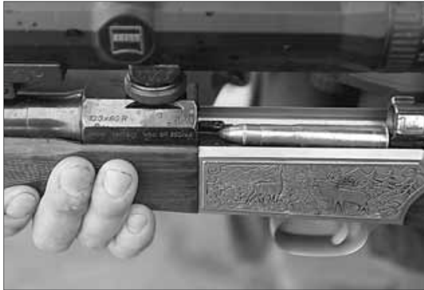
Luis Cahannes schießt mit einem Teilmantelgeschoss, Kaliber 10,3 Millimeter. Die Jagdbehörde fordert ein Mindestkaliber von 10,2 Millimeter.
